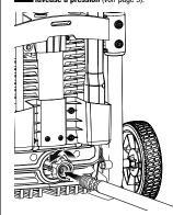
Desenrolle completamente la manguera de jardin o quítela completamente del carrete para evitar la formación de acodaduras.
