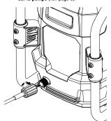
Connexion du tuyau d'arrosage au laveuse à pression (voir page 9).
