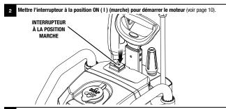
Une fois fini, mettre l'interrupteur à la position OFF ( 0 ) (arrêt) pour arrêter le moteur (voir page 10).
