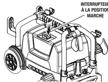
**3** Une fois fini, mettre l'interrupteur à la position OFF (0) (arrêt) pour arrêter le moteur (voir page 10).
