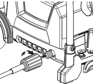
**5** Connexion du tuyau d'arrosage au laveuse à pression (voir page 9).
