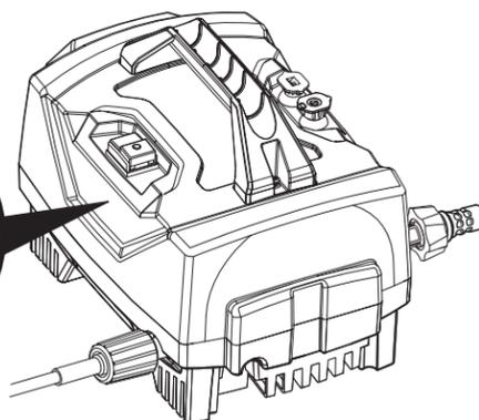
3 Une fois fini, mettre l'interrupteur à la position OFF ( 0 ) (arrêt) pour arrêter le moteur (voir page 10).
