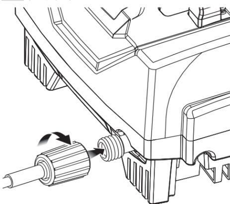
5 Connexion du tuyau d'arrosage au nettoyeur haute pression (voir page 9).
