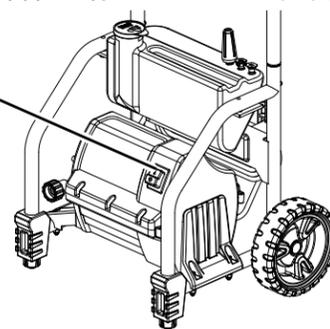
3 Une fois fini, mettre l'interrupteur à la position OFF (0) (arrêt) pour arrêter le moteur (voir page 11).
