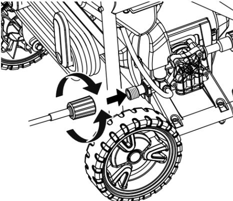
7 Connexion du tuyau d'arrosage au nettoyeur haute pression (voir page 10).
