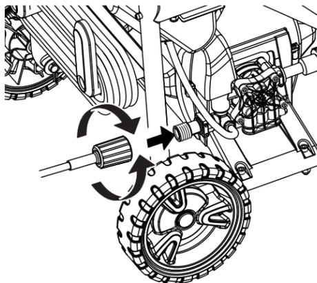
7 Connexion du tuyau d'arrosage au nettoyeur haute pression (voir page 10).
