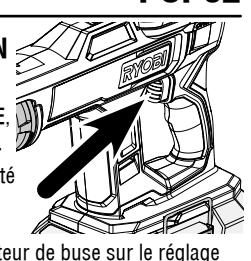
**NOTE :** Si le pulvérisateur a de la difficulté à s'amorcer ou ne pulvérise pas quand le réservoir est plein, la pompe est désamorcée. Tourner le cadran du sélecteur de buse sur le réglage de micron le plus grand et tirer sur la gâchette de l'interrupteur. Une fois le jet homogène et constant, relâcher la gâchette de l'interrupteur et tourner le cadran du sélecteur de buse sur la position souhaitée.
