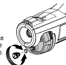
tourner la buse en sens horaire jusqu'à ce que le joint torique en O soit scellé contre la face du sélecteur de mode. Ne pas trop serrer.
