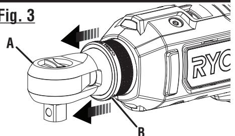
A - Ratchet head (tête à rochet, cabezal de trinquete)
