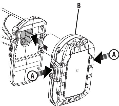
A - Depress latches to release battery pack (appuyer sur le loquet pour retirer le bloc-piles, para soltar el paquete de baterías oprima los pestillos)
