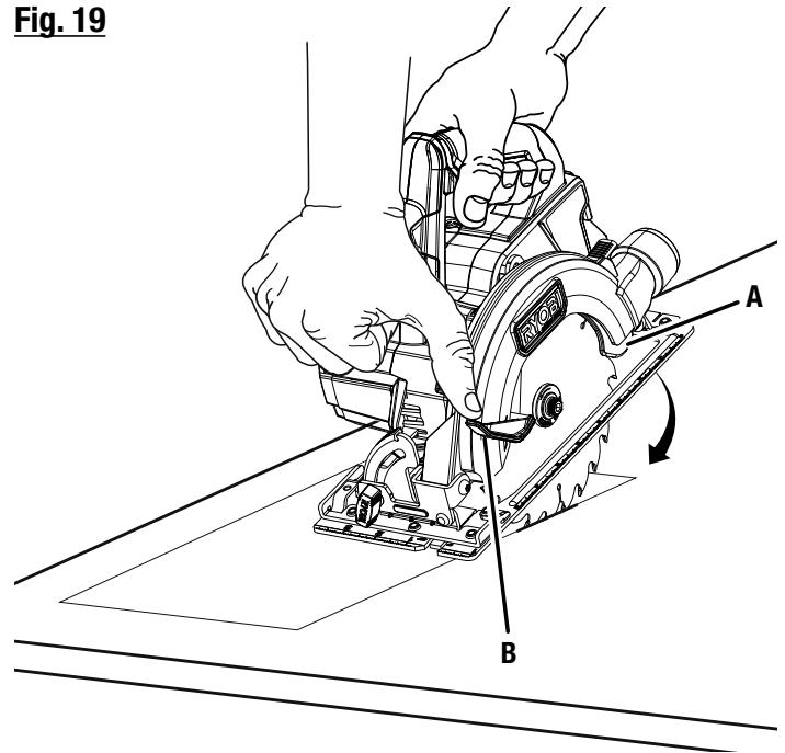
A - Lower blade guard (garde de lame inférieure, protección inferior de la hoja)
