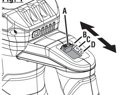
A - Speed switch (interrupteur de vitesse, interruptor de velocidad)
