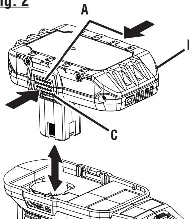
A - Depress latches to release battery pack (appuyer sur les loquets pour libérer le bloc-pile, para soltar el paquete de baterías oprima los pestillos)
