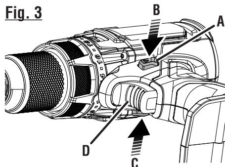
A - Direction of rotation selector (forward/reverse/center lock) [sélecteur de sens de rotation (avant/arrière/verrouillage central), selector de sentido de rotación (adelante/atrás, seguro en el centro)]
