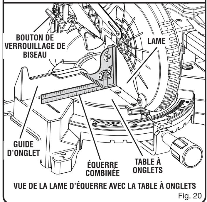
VUE DE LA LAME D'ÉQUERRE AVEC LA TABLE À ONGLETS
