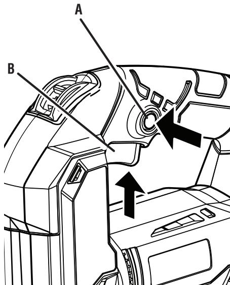
A - Lock-on button (bouton de verrouillage, botón del seguro de encendido)
