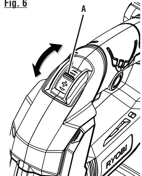
A - Variable speed lever (gâchette à vitesse variable, palanca de velocidad variable)
