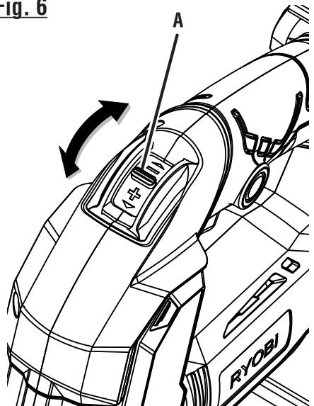
A - Variable speed lever (gâchette à vitesse variable, palanca de velocidad variable)
