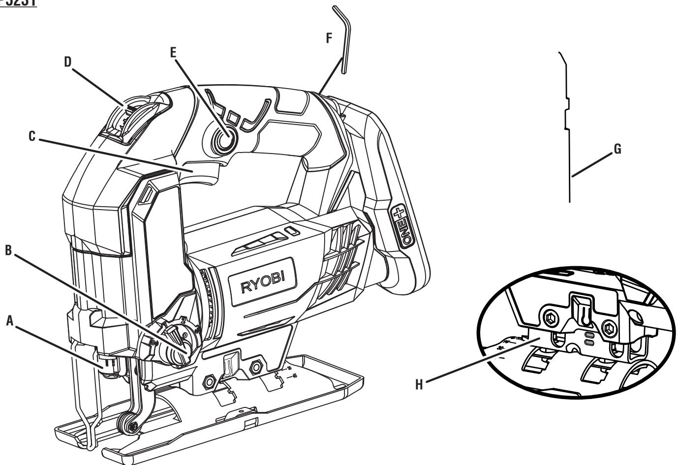
A - Toolless blade clamp (verrouillage du porte-lame, mordaza de la hoja de apriete sin herramienta)
