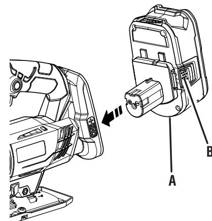
A - Battery pack (bloc-piles, paquete de baterías)
