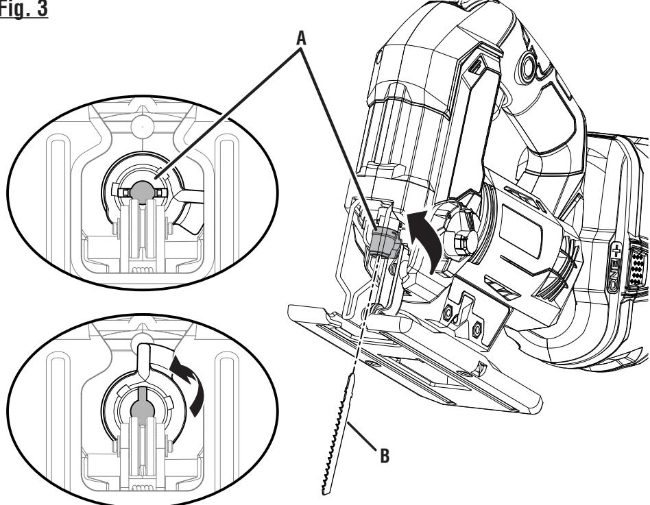
A - Toolless blade clamp (verrouillage du porte-lame, mordaza de la hoja de apriete sin herramienta)
