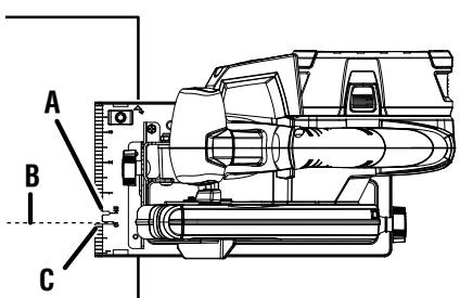
A - 45° blade guide notch (encoche guide de lame de 45°, muesca guía de la hoja de 45°)
