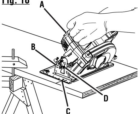
A - Motor housing (boîtier du moteur, alojamiento del motor)
