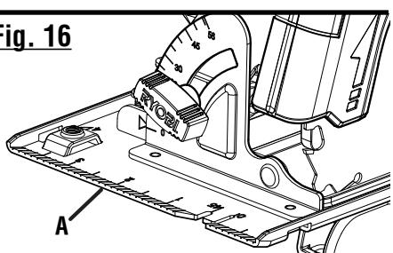
A - Width of cut scale (échelle de largeur de la coupe, ancho de corte)
