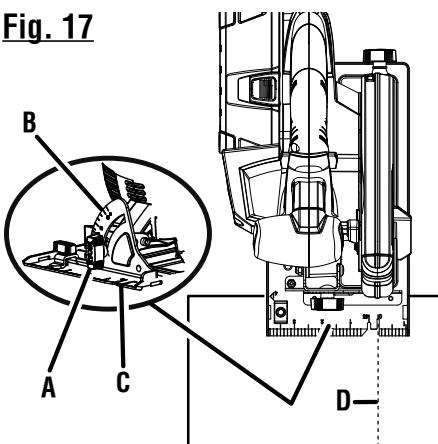
A - Bevel lock knob (bouton de verrouillage de biseau, perilla de fijación de bisel)
