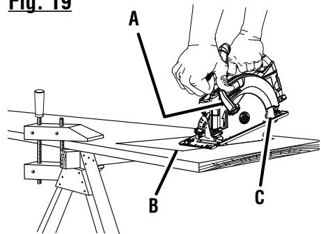
A - Lower blade guard handle (poignée de garde de lame inférieur, manija de la protección inferior de la hoja)
