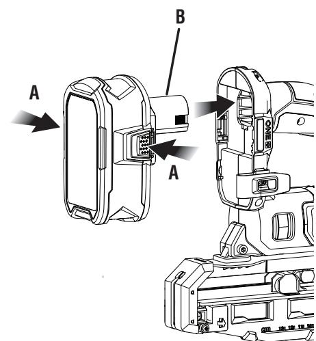
A - Depress latches (appuyer sur les loquet(s), para soltar el paquete de pilas oprima los pestillos)
