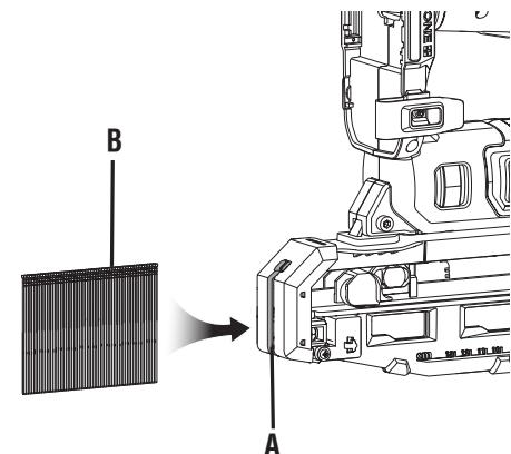
A - Rear loading magazine (magasin à chargement arrière, cargador de carga trasero)
