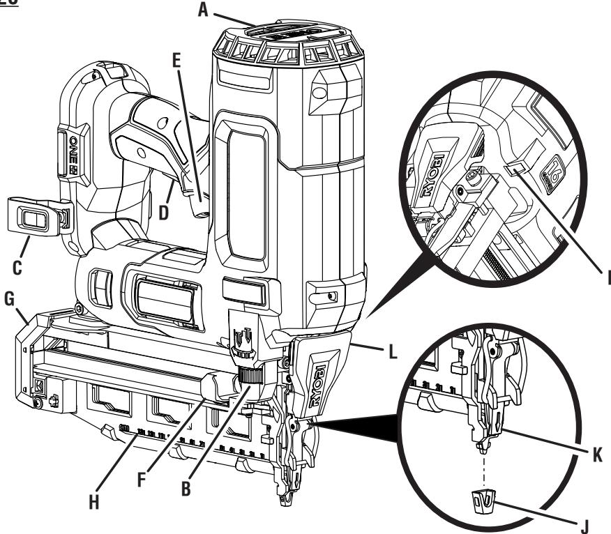
A - Air pressure lever (levier de pression d'air, palanca de presión de aire)
