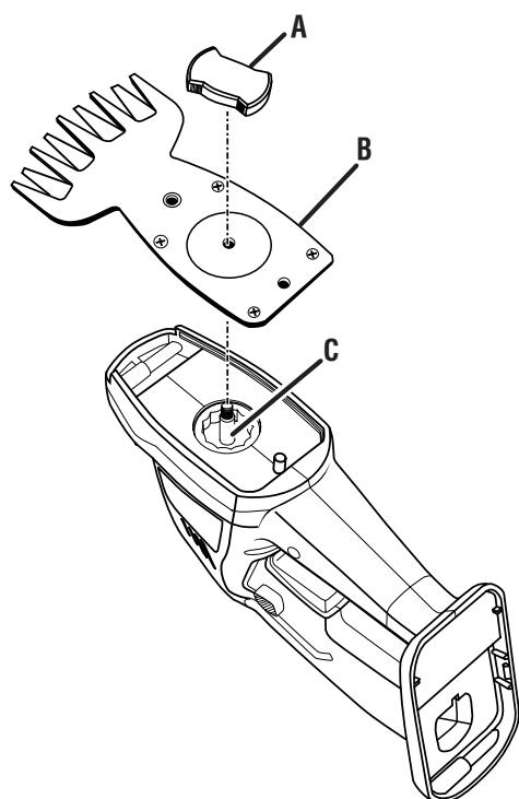
A - Lock knob (bouton de verrouillage, perilla de fijación)
