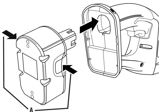
A - Depress latches to release battery pack (appuyer sur les loquets pour libérer le bloc-pile, para soltar el paquete de batería oprima los pestillos)
