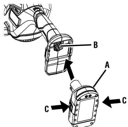
A - Battery pack (bloc-piles, paquete de baterías)
