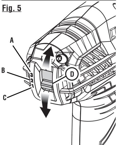
A - HIGH Speed/Torque (3) [vitesse/couple RAPIDE (3), ALTA velocidad/torsión (3)]
