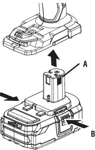
A - Battery pack (bloc-piles, paquete de baterías)
