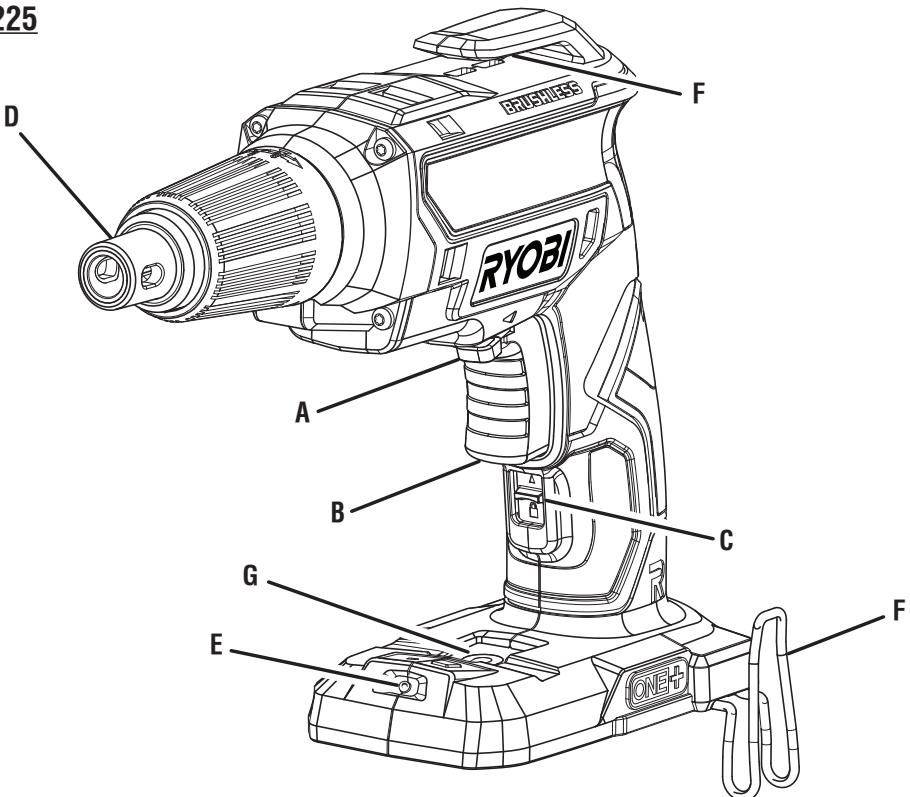
A - Direction of rotation selector (forward/reverse/center lock) [(sélecteur de sens de rotation (avant / arrière / verrouillage central), selector de sentido de rotación (adelante/atrás/seguro en el centro))]
