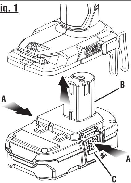
A - Depress latches to release battery pack (appuyer sur les loquets pour libérer le bloc-pile, para soltar el paquete de baterías oprima los pestillos)
