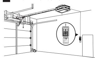
Cablee el panel interior y los sensores de seguridad (vea la página 32 y 33). NOTA: Pele 12,7 mm (1/2 pulg.) de aislamiento desde los extremos de cada cable antes de la instalación.
