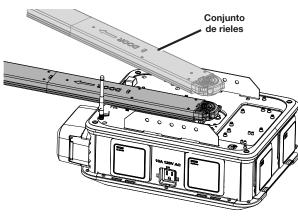
Fije el conjunto de rieles al cabezal de alimentación. Eleve la antena Wi-Fi hasta la posición vertical
