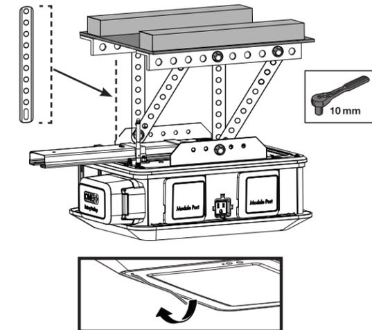
Retirer le ruban et placer l'antenne RF sous l'ouvre-porte de garage afin d'obtenir une meilleure réception du signal entre l'ouvre-porte et le clavier extérieur.
