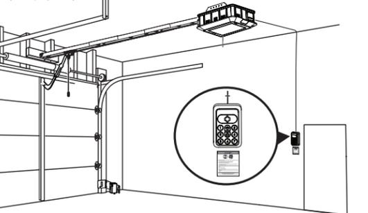
**11** Câbler le clavier intérieur et les capteurs de sécurité (voir pages 32 et 33). **NOTE :** Dénuder l'isolant sur 12,7 mm (1/2 po) aux extrémités de chaque fil avant de les raccorder.
