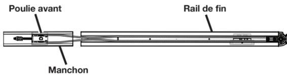
**2** Insérer le chariot extérieur dans l'extrémité du rail. Glisser simultanément les chariots intérieur et extérieur jusqu'à ce qu'ils s'engagent. (Voir page 16).
