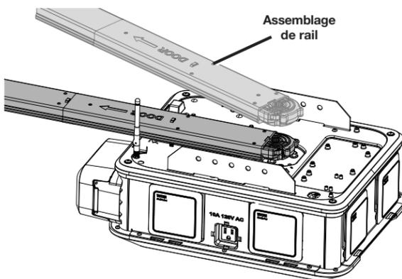
**8** Fixer fermement l'assemblage du rail au moteur. Relever l'antenne Wi-Fi à la verticale. (Voir page 19).
