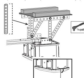
Remueva la cinta adhesiva y ubique la antena RF debajo del abridor de puerta de cochera para una mejor recepción de señal entre su abridor y el panel exterior.
