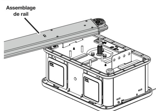
**8** Fixer fermement l'assemblage du rail au moteur. Relever l'antenne Wi-Fi à la verticale. (Voir page 18.)
