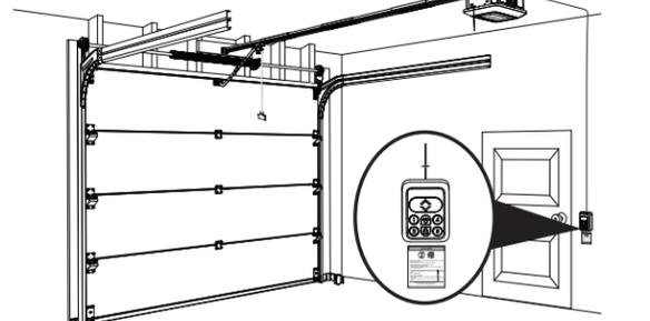
**11** Câbler le clavier intérieur et les capteurs de sécurité. (Voir pages 30 à 32.)
