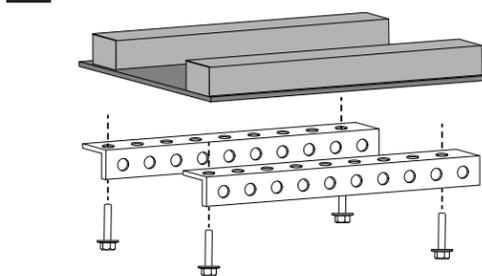
**5** Mesurer et couper les supports de montage en ajoutant une longueur de 12,7 mm (1/2 po) à la distance mesurée entre le support de solive et le plafond. Mesurer et couper les traverses. Monter le moteur au plafond. (Voir page 25.)
