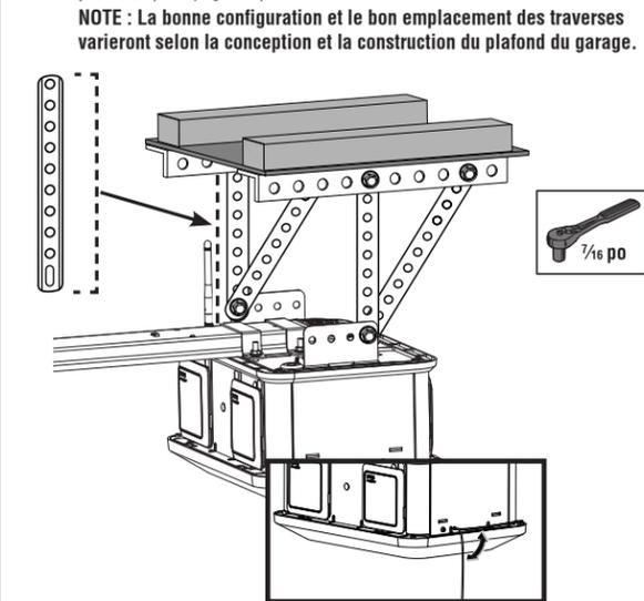
Retirer le ruban et placer l'antenne RF sous l'ouvre-porte de garage afin d'obtenir une meilleure réception du signal entre l'ouvre-porte et le clavier extérieur.
