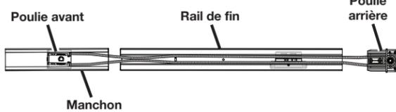
**2** Insérer le chariot extérieur dans l'extrémité du rail. Glisser simultanément les chariots intérieur et extérieur jusqu'à ce qu'ils s'engagent. (Voir page 15.)
