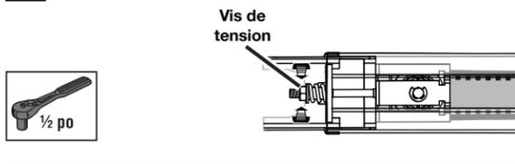
**7** Positionner l'assemblage de rail sur le moteur. (Voir page 18.)
