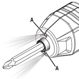
A - LED light (lampe à DEL, diodo luminiscente)
