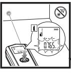
Appuyer sur le bouton d'accueil pour prendre la mesure. La distance est mesurée depuis l'arrière de l'appareil.
