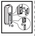
Retire la tapa de la batería. Hay dos pilas AAA preinstaladas. Tire de la lengüeta para activar las baterías. Vuelva a colocar la tapa.
