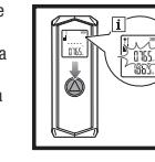
Presione el botón de inicio para bloquear la medición. Solo se guarda la última medición.
