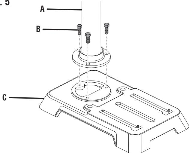
A - Column assembly (colonne, conjunto de la columna)
