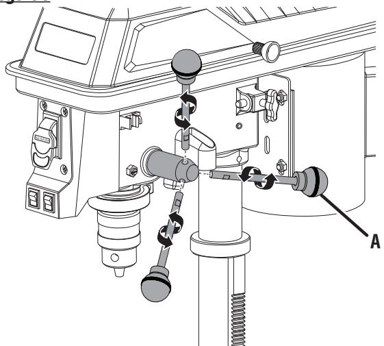
A - Feed handle (levier de commande, palanca de avance)
