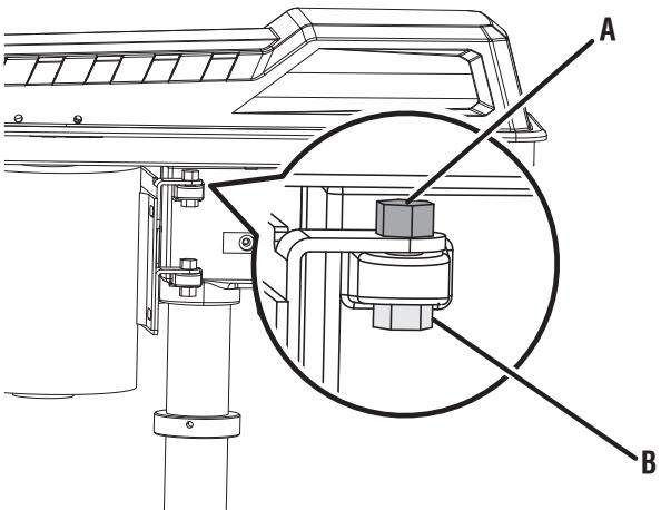
A - Pivot bolt (boulon de pivot, perno de pivote)
