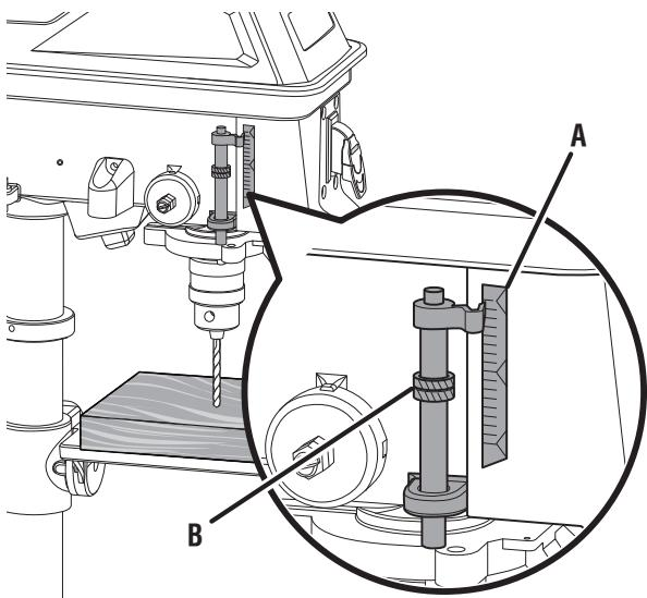
A - Depth gauge (limiteur de profondeur, graduador de profundidad)
