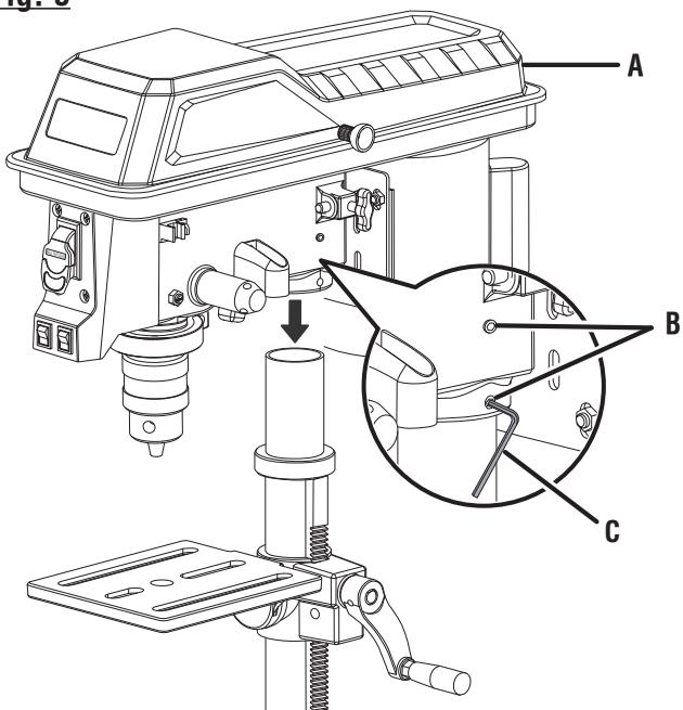
A - Head assembly (tête de la perceuse, conjunto del cabezal)
