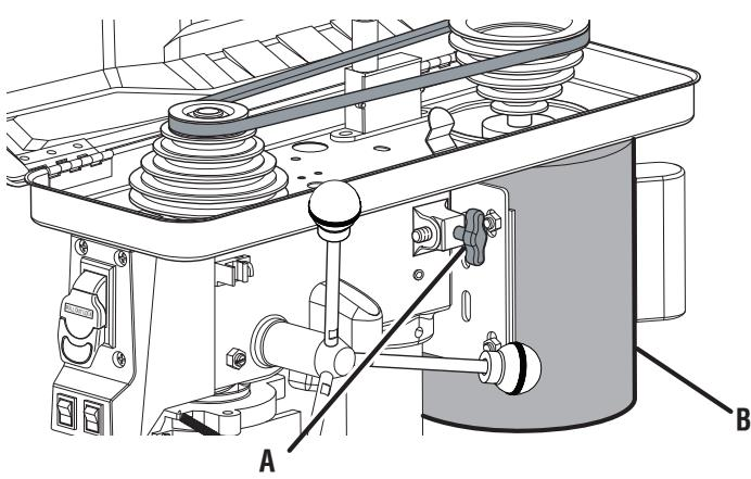
A - Tension bolt (boulon de tension, perno de tensión)
