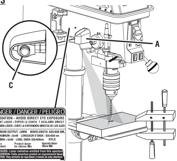
A - Laser housing (boîtier de laser, alojamiento del láser)
