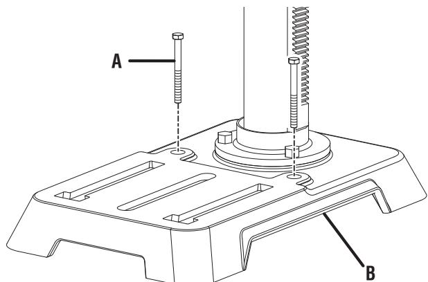
A - Mounting bolts (boulons de montage, pernos de montaje)
