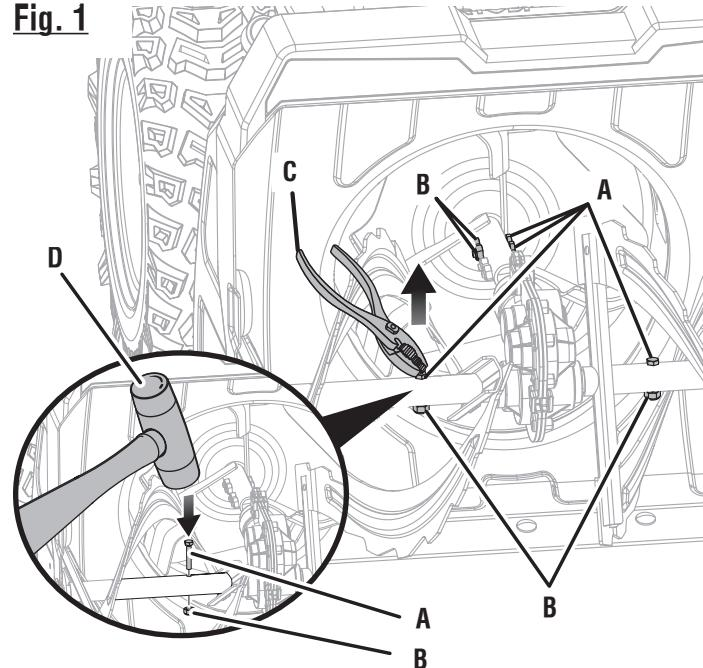
A - Shear pins (goupilles de cisaillement, pasadores de seguridad)
